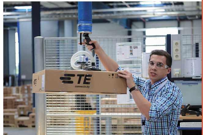
Unidade de elevação com rótula giratória para movimentação horizontal, vertical ou basculante de cargas.
