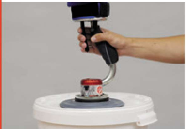
Unidade de elevação com cabeça fixa movimentação puramente horizontal ou de cargas em movimento.
