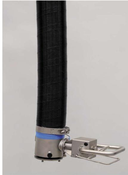
Unidade de elevação com rótula superior, terminal de sucção e unidade de controle feitos inteiramente em aço inoxidável. Para as exigências ATEX, o tubo de elevação recebe um revestimento antiestático especial e uma inserção interna de fio de cobre aberta. Todos os componentes são conectados eletricamente, para garantir a equalização de potencial necessária.
