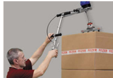
Unidade de elevação com rótula giratória para movimentação horizontal, vertical ou basculante de cargas.
