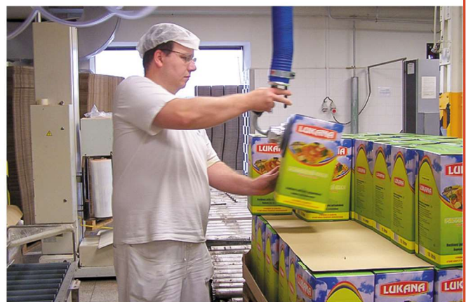
Unidade de controle MultiStacker para manipulação de materiais em qualquer altura.
